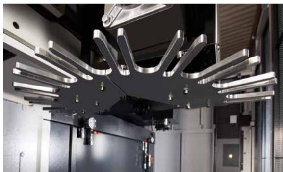
Changeur d'électrodes du modèle EA8S avec dix emplacements dans le magasin
