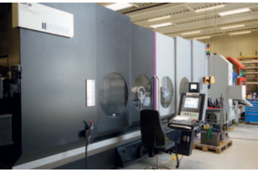
Das Konzept der Ibarmia-Maschine überzeugte hinsichtlich der Fahrständertechnologie mit der Möglichkeit durch Einsatz der optional erhältlichen Trennwand zwei unabhängige Arbeitsräume zu schaffen.
