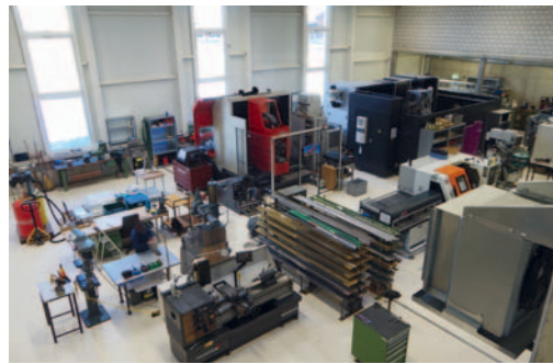
Auf Anfrage bei Ibarmia wurde Inducta eine platzsparende Aufstellungsvariante angeboten, die den Kühlmitteltank auf den querfördernden Späneförderer platziert (im Bild hinten rechts).
